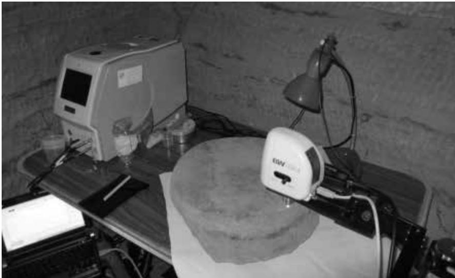
Figura 2. Estudio de los restos de pigmentos en un molino de piedra mediante espectroscopia Raman.
