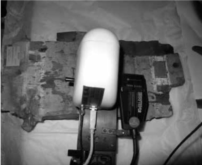
Figura 1. Medición en un fragmento de ataúd. El microscopio está acoplado a una sonda Raman que permite la identificación de los pigmentos.
