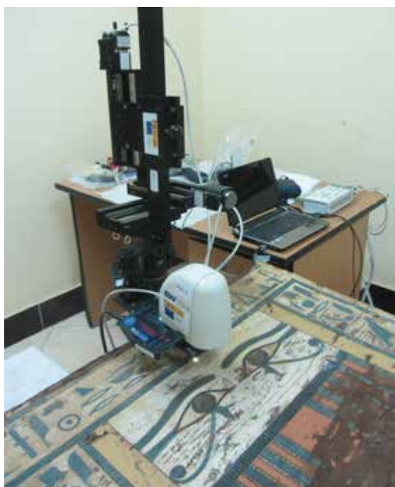
Figura 144. Microespectrómetro Raman portátil.
