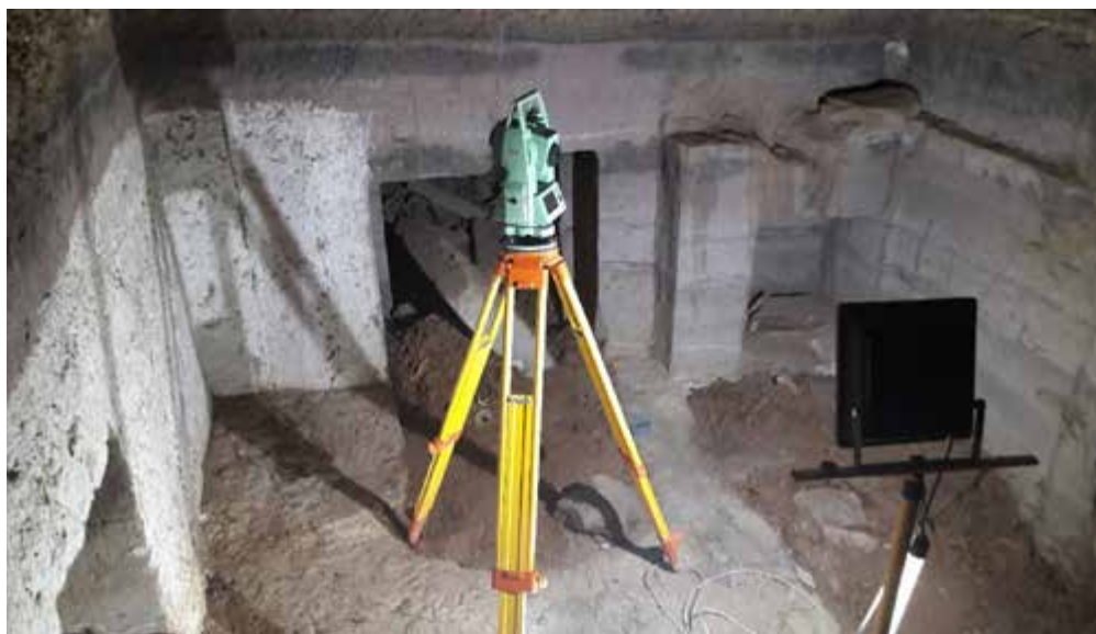
Figura 169. Estación total Leica TCR407 Ultra, estacionada en QH32.
