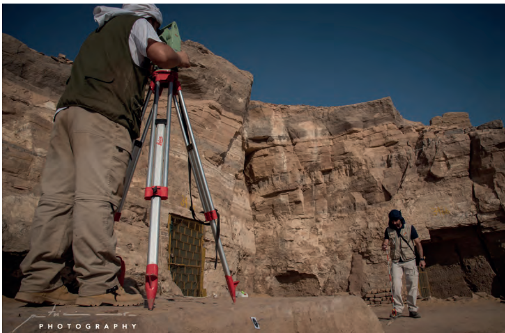
Figura 19. Realización de los trabajos fotogramétricos con un escáner láser terrestre (TLS) (Mora Riudavets 2019 ©Universidad de Jaén).
