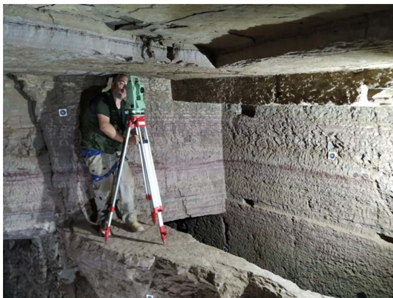
Figura 34. Trabajos Topográficos utilizando una estación total.
